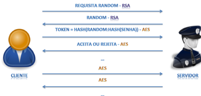
Figura 3: Processo de autenticação e posterior troca de dados entre cliente e servidor.
